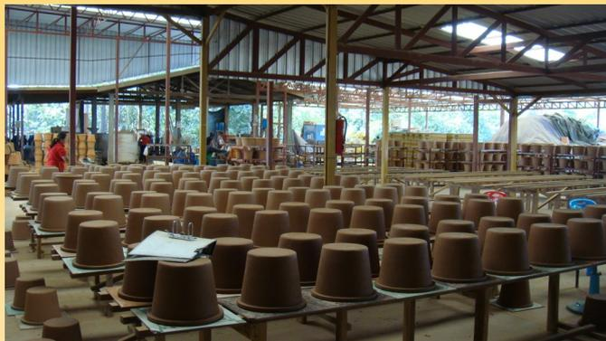
Implantée localement, Terra Clear produit et vend à un prix abordable des filtres en céramique frottés à l'argent colloïdal. Ces filtres sont fabriqués à partir d'argile purifiée et de balle de riz trouvées localement, puis sont intégrés à un récipient en plastique importé de Thaïlande.
